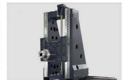
Стойка имеет большую треугольную конструкцию, что улучшает сейсмические характеристики и делает обработку более стабильной.
