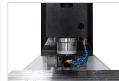
Головка машины. Головка коробчатого типа с ребрами жесткости обладает повышенной стабильностью.
