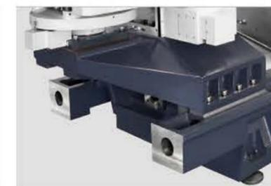
Основание имеет большой пролет, что обеспечивает устойчивость всей машины. Важнейшие компоненты прошли анализ методом конечных элементов, что позволило обеспечить стабильность и прочность машины.
