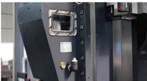
Двухскоростной редуктор (шпиндель может быть оснащен двухскоростным редуктором)
