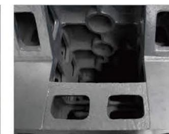
Двухслойная коробчатая конструкция стойки и основания
