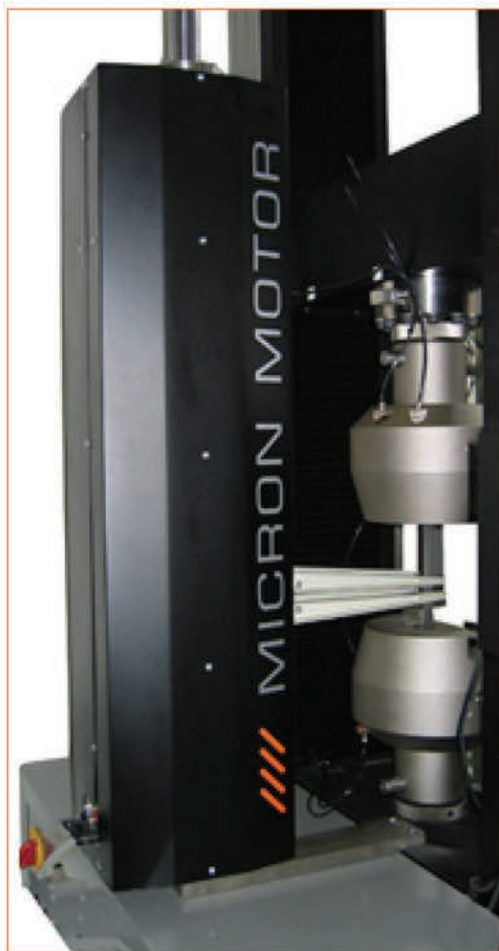
Полностью моторизированные автоматические экстензометры серии Micron Motor
