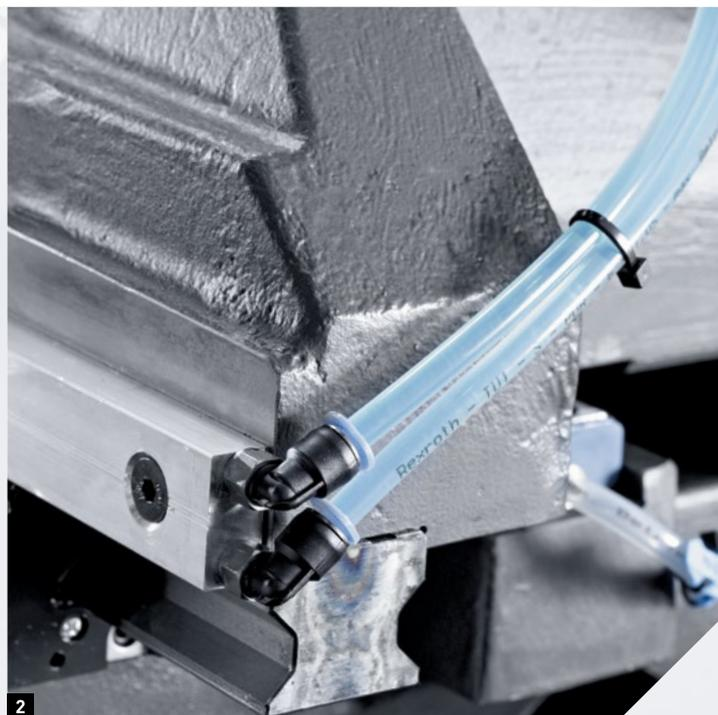
1+2: охлаждение гаек шарико-винтовой пары и направляющих
