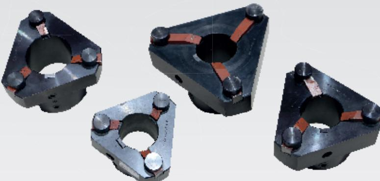
3-х резцовые расточные головки используются в комбинации с борштангами VT80/ VT100 и предназначены для получения сложных, глубоких и сквозных отверстий с высокими требованиями к точности и чистоте обработки детали.
