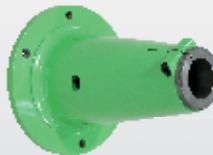
Зажимной фланец SP100-500 значительно повышает жесткость посадки рабочего шпинделя, что позволяет использовать станок с максимальной точностью обработки при пониженных оборотах и выдвинутом шпинделе более 500 мм без возможности перемещения по оси W.
