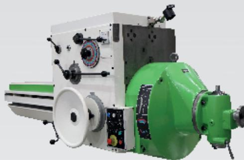
Фрезерная головка FP40-100 позволяет фрезеровать как на базовых, так и наклонных плоскостях параллельно оси шпинделя или сверлить в базовых плоскостях, перпендикулярных оси шпинделя.
