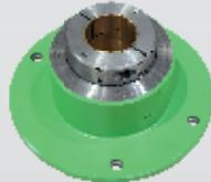
Зажимной фланец SP100/800 повышает жесткость посадки рабочего шпинделя, что позволяет повысить точность обработки при средних оборотах и выдвинутом шпинделе более 200 мм без возможности перемещения по оси W.
