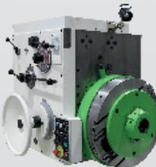
Зажимной фланец SP100 повышает жесткость посадки рабочего шпинделя, что позволяет использовать оборудование при выдвинутом шпинделе более 110мм при пониженных оборотах шпинделя без возможности перемещения по оси W.
