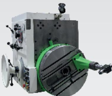
Телескопический позиционер резца TD50 при работе с планшайбой служит для обработки труднодоступных внешних и внутренних поверхностей большого диаметра.
