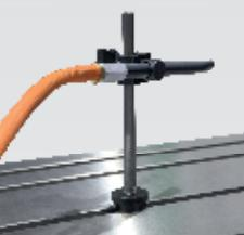
Устройство предназначено для охлаждения инструмента охлаждающей жидкостью, подаваемой через форсунки.
