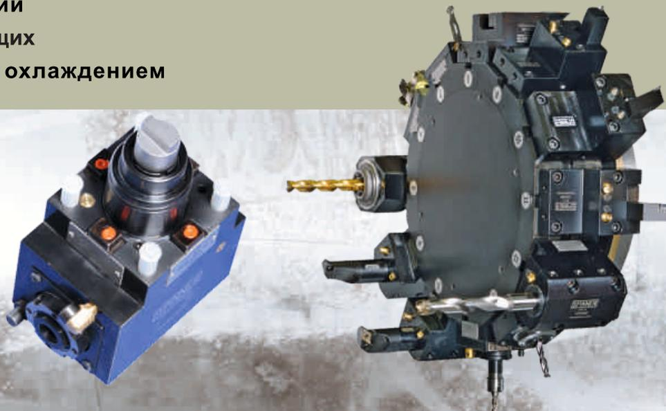
Пассивная система демпфирования (гашения вибрации)
