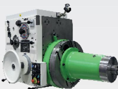
Направляющая опора значительно повышает жесткость посадки и оси вращения рабочего шпинделя, что позволяет использовать станок с максимальной точностью при черновой и чистовой обработке в полном диапазоне оборотов и при выдвинутом шпинделе.
